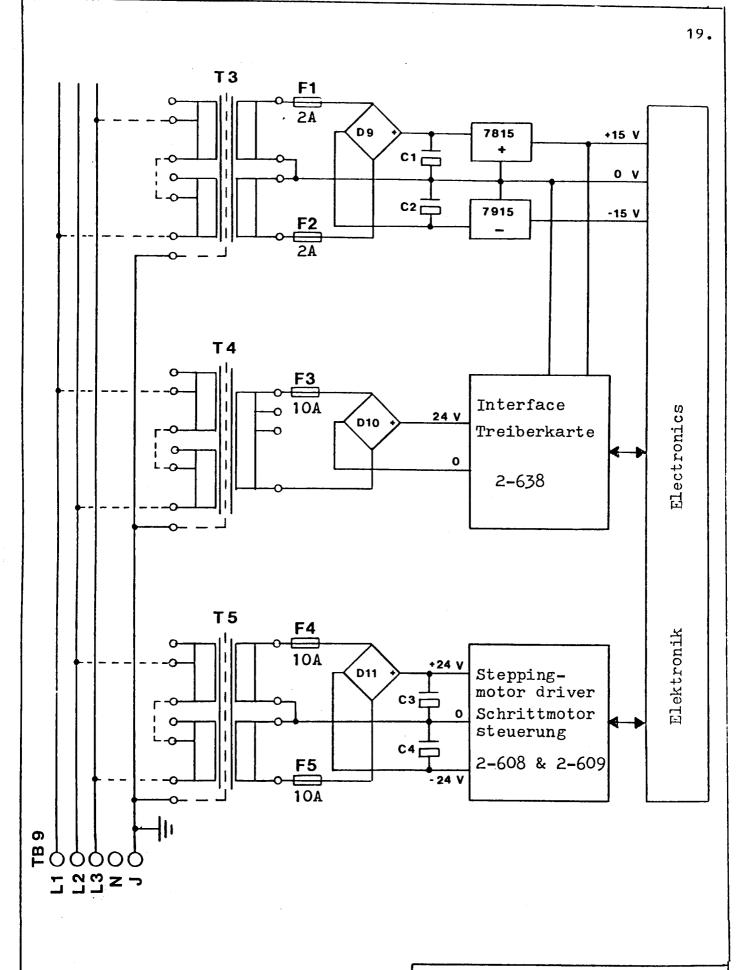
Strømforsyning til elektronik Power supply for electronics Stromversorgung für elektronik
